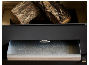
Rystgallret rörs fram och tillbaka för att leda ner askan i asklådan.
